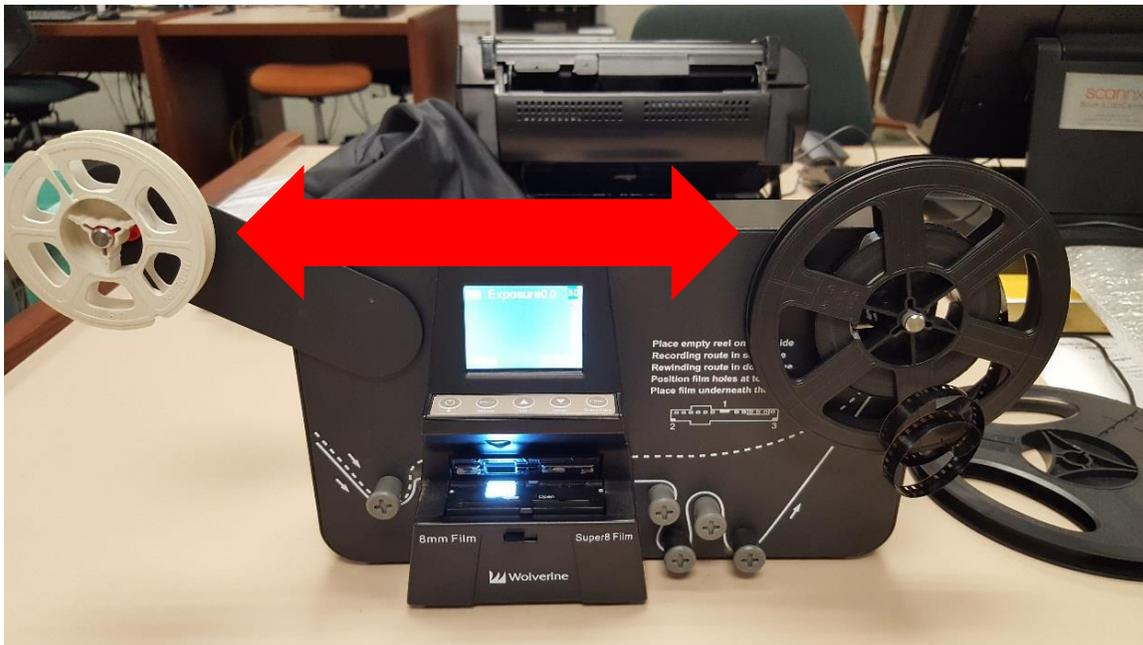
4. Passez le film de gauche à droite en suivant le tracé pointillé. Important : assurez-vous que les trous de montage du film sont vers vous et non vers la machine. Si non, le film sera rembobiné de la fin vers le début.
